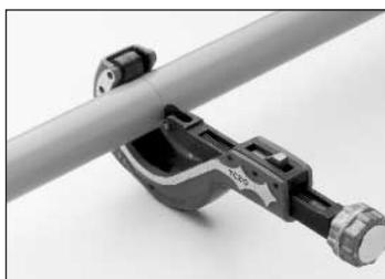
superficie de la tubería. Si en el extremo de la tubería hay evidencia de cualquier daño o agrietamiento, corte por lo menos 50.8 mm (2 pulgadas) más allá de cualquier daño visible.
